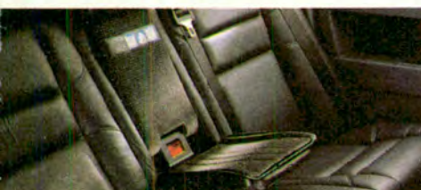
Al rebatir el apoyabrazos del asiento trasero y levantar una tapa, se forma un asiento especial para niños de 3 a 10 años.
